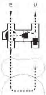
Automatische bypass tijdens regeneratie. Klep gaat automatisch open en laat onbehandeld water door
