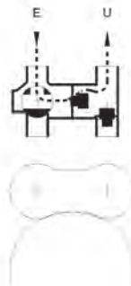
Automatischer Bypass System außer Betrieb
