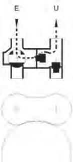
Bypass automatico Posizione di sezionamento impianto
