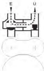
Bypass manuale - Posizione di sezionamento impianto
