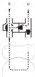
Automatischer Bypass Regeneration. Automatisches Ventil für Rohwasser-Bypass geöffnet
